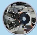
INSPECTION 全錠剤の割れ、欠け、 色の不具合などを自動検査
